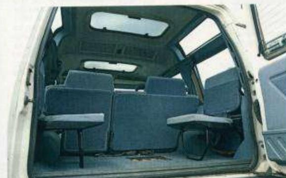
Les strapontins permettaient d'offrir les 7 places et sont à l'origine de la forme si particulière du toit à deux étages afin de laisser du volume aux têtes des occupants.
