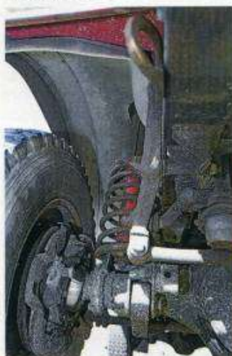
Révolution, la suspension à ressorts hélicoïdaux s'invite sous un Land Rover, une technologie jusqu'alors réservée au Range Rover depuis 1970 !
