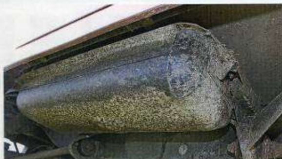
Le réservoir sur mesure est placé sous la caisse entre les supports des tirants.
