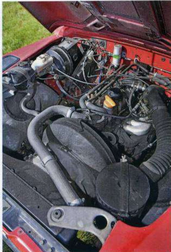
Pas de révolution sous le capot, on retrouve le 2.25L essence de série, cependant un des prototypes était propulsé par un V8 de Stage One.
