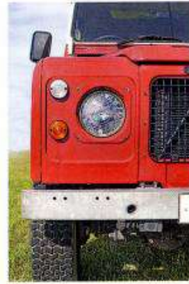
Le pare-chocs, galvanisé, présente des supports pour un cric agricole ainsi que des perçages permettant d'installer le double pare-chocs.
