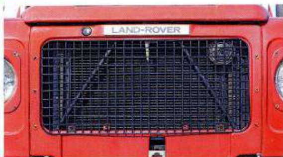
La calandre provient directement des Series III Stage One avec cette position avancée, affleurant les ailes et la grille métallique.
