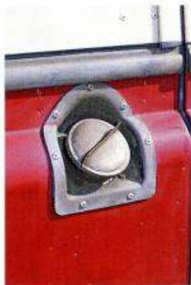
On retrouve la position haute de la goulotte de remplissage des Series. Elle sera complètement modifiée sur le Ninety final.
