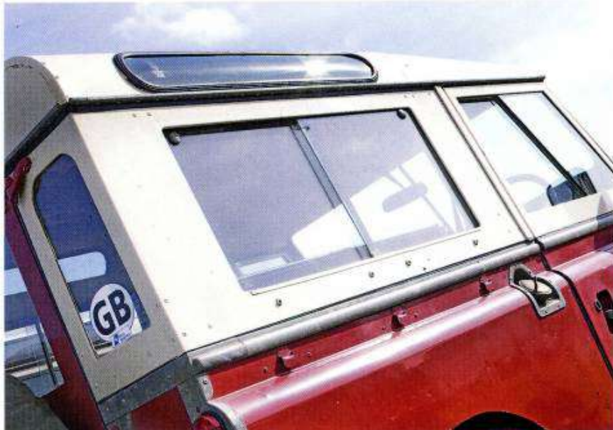
Les cotés du hard-top sont des éléments de Series III modifiés et allongés, agrémentés d'une bande de finition au niveau de la porte compensant l'allongement de la caisse.
