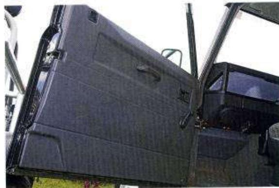
Les portes sont plus longues que celle d'origine afin de faciliter l'accès aux places arrière. Ultra légères, elles sont réalisées en aluminium, jusqu'aux charnières. Les contre-portes ont été réalisées spécialement.
