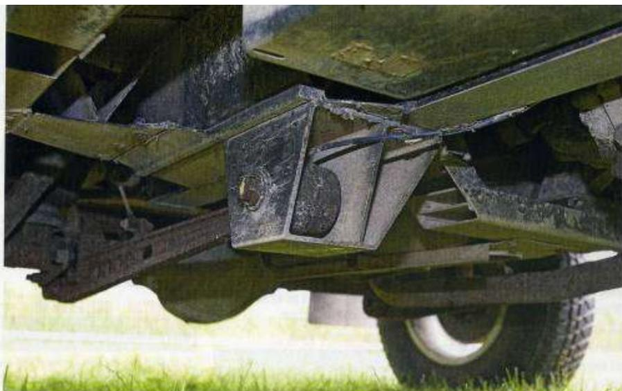
La configuration avec tirants de pont est conservée en optant cependant pour des tirants en alliage et des supports collés à la coque. Malheureusement cette solution ne répondait pas aux impératifs des crachs tests. Le pont arrière bénéficie de ressorts pneumatiques empruntés au Range P38, là encore, sans suite sur le Defender de série.
