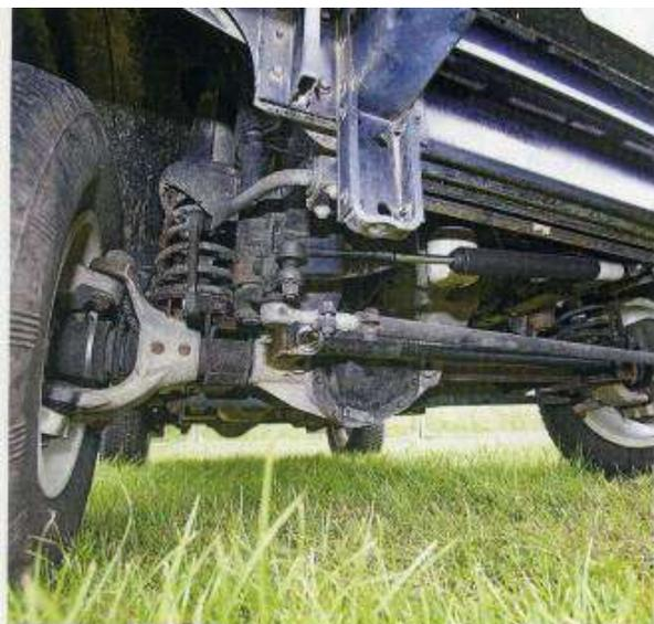
Plus moderne que les sphères de direction, des fusées et des cardans offrent une précision de direction accrue et bien sûr un poids inférieur. Nous sommes bien loin des antiques ponts Land Rover. Des éléments Dana avec corps de différentiels et fusées en aluminium permettent à eux seuls de gagner près de 60 kg.
