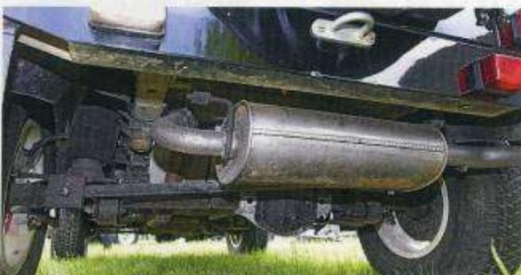
La traverse arrière n'a pas de fonction structurelle comme sur le Land de série. Elle sert principalement de garniture masquant les profilés de la caisse. Malgré l'anneau de traction, impossible de tracter avec ce proto.
