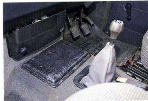
Le tunnel de boîte reçoit les leviers de vitesses, le frein à main et l'extincteur, installés systématiquement sur tous les prototypes. L'ensemble des boîtiers électriques et des fusibles est placé à l'avant du tunnel. Les "Rangistes" reconnaîtront les commandes de boîte et de transfert d'un Classic.
