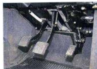
Le pédalier est un mélange d'éléments de Defender et de pièces réalisées spécialement.
