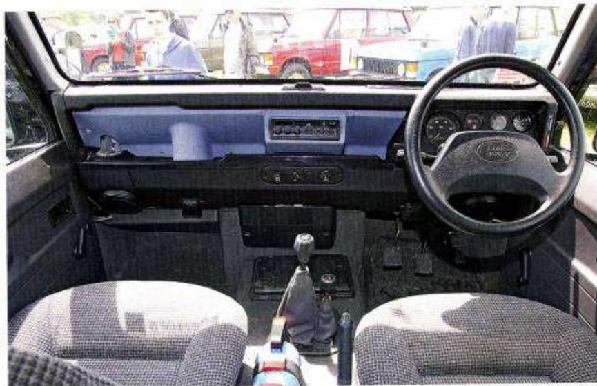
Si le tableau de bord et le volant restent d'origine, les ressemblances avec un Defender de série s'arrêtent là. Plancher, sièges, commandes et tunnel de boîte sont inédits.
