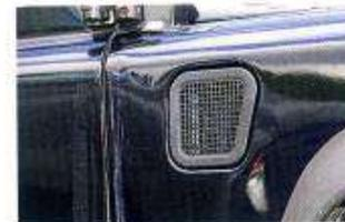
Le tablier inédit supprime la nécessité d'avoir un montant vertical entre la porte et l'aile. La prise d'air reste d'origine.
