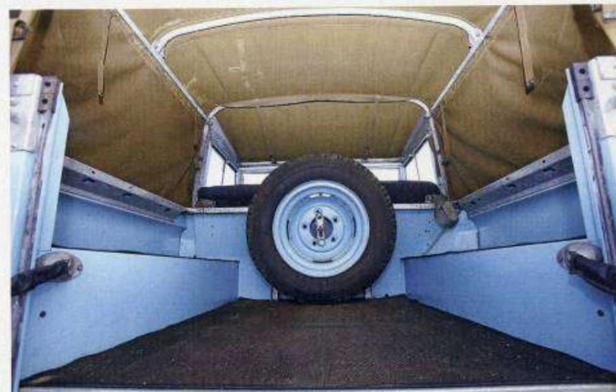
Après avoir connu plusieurs vies et deux configurations et couleurs de carrosserie, la SIIA a retrouvé son toit bâché et sa benne intégralement reconditionnés jusqu'au panneau de ridelle galvanisé.
