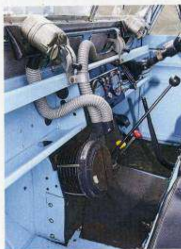
Le tablier est sensiblement modifié afin de recevoir le bloc moteur et la cloche d'embrayage, la cloison affleurant la commande de boîte de vitesses.
