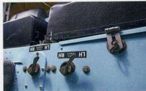
Glouton, le V8 a demandé l'installation de deux réservoirs, une configuration existante à l'époque sur les modèles de l'Armée.
