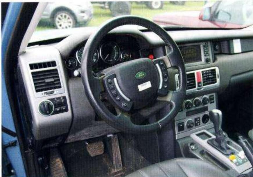
Dans l'ensemble, l'habitacle est proche du modèle de série, cependant certains éléments n'ont pas leur rendu texturé. Également, le volant et la planche de bord côté passager indiquent la déconnexion des airbags.
