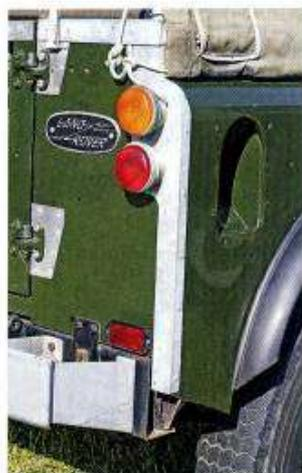
En plus de disposer d'un empattement unique, les 100" reprennent un arrière train de Land 90, réduit au minimum. La traverse arrière, légèrement modifiée, provient d'une Series III.
