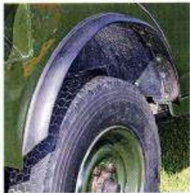
Les ailes largement échancrées laissent évoluer les roues en 750x16 équipées de Michelin X. Tous les panneaux de carrosserie sont uniques aux 100 : ailes avec trappe à carburant pour le réservoir auxiliaire (non monté ici), passage d'aile, cornière galvanisée et bien sûr élargisseur d'aile. Les jantes en tôle proviennent de la gamme de l'époque et cachent des freins à tambours.
