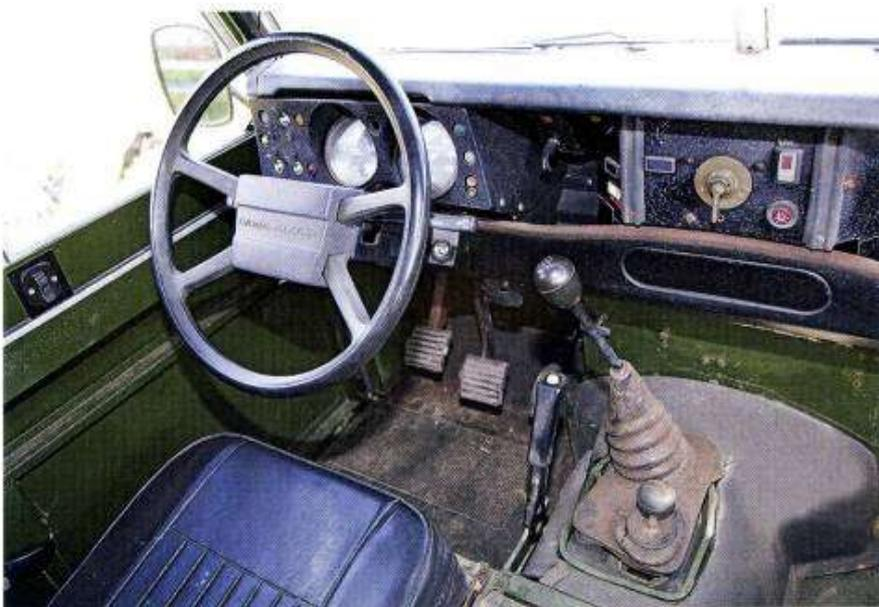
L'habitacle ressemble de prime abord à celui d'une Serie III militaire, cependant le volant de Range trahit l'origine des soubassements du Land. Il en est de même pour la boîte de vitesses et ses commandes provenant directement du Range.
