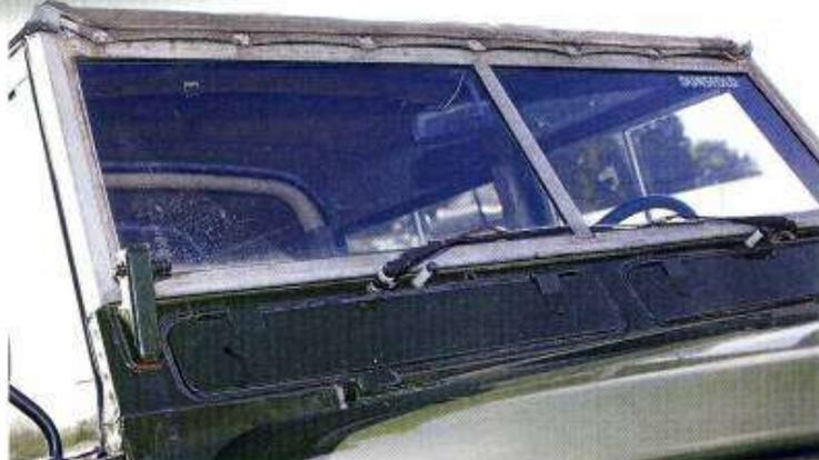
On retrouve un pare-brise de Serie III sur ce Land 100". Ceux directement produits pour la Suisse disposaient de pare-brises plus hauts, préfigurant ceux du Land Rover Ninety et One Ten. Cela à priori pour permettre de voir les feux tricolores placés plus en hauteur en Suisse, mais également en anticipation des nouvelles normes en vigueur à travers l'Europe.
