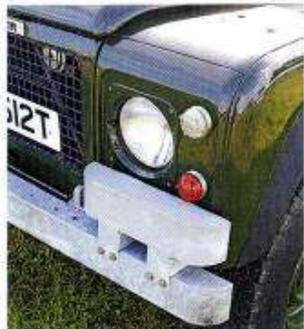
On retrouve logiquement les double pare-chocs des Series III militaires ainsi que les cabochons que l'on visse à la main. Véritable scoop à l'époque : l'armée s'est vu présenter les 100" équipés du capot et de la calandre avancée du futur "Stage One" permettant l'implantation du V8 Range Rover, un an avant sa commercialisation.
