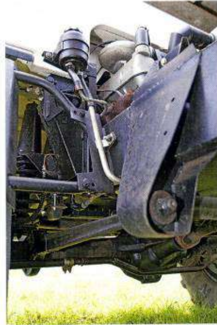
D'aspect identiques aux supports de tirants de Land, ceux du Llama sont en fait bien plus imposants.
