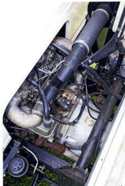
Le V8 emprunté au Range Rover et au Stage One, réglé à 110 ch propose des performances suffisantes pour un utilitaire. Malheureusement, l'armée venait de décider d'uniformiser ses flottes au gazole !
