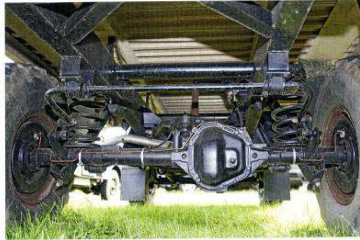
Comme à l'avant, les supports sont énormes comparés à ceux d'un Land. Ils reçoivent des tirants d'origine couplés au pont Salisbury élargi. Ce dernier bénéficie d'un différentiel à glissement limité. La configuration à ressorts hélicoïdaux et barre stabilisatrice n'a pas convenu au cahier des charges de l'armée.
