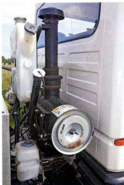
Le filtre à air et réservoir sont placés le plus haut possible, entre la cellule et la benne.
