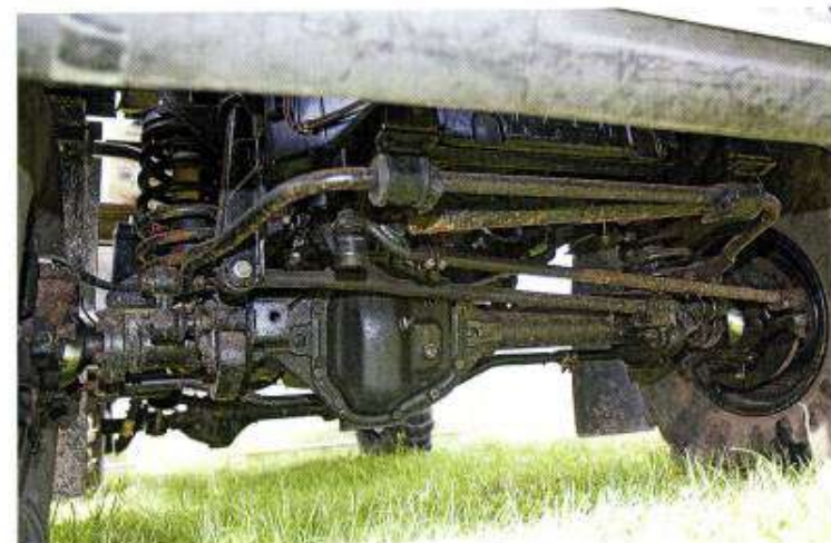
Le pont avant provient de chez Salisbury, fournisseur historique de Land Rover. Il a bénéficié d'un élargissement afin d'offrir des voies en rapport avec la dimension et la mission du Llama.
