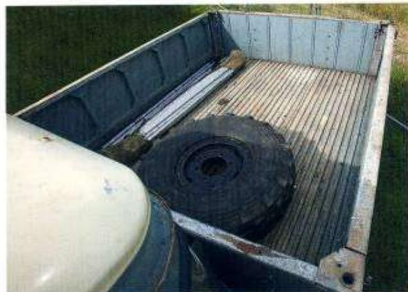
La benne façon pick-up est généreuse et pratique avec ses trois ridelles. L'imposante roue de secours limite tout de même la surface au sol, mais des arceaux d'époque permettent de bâcher l'ensemble.
