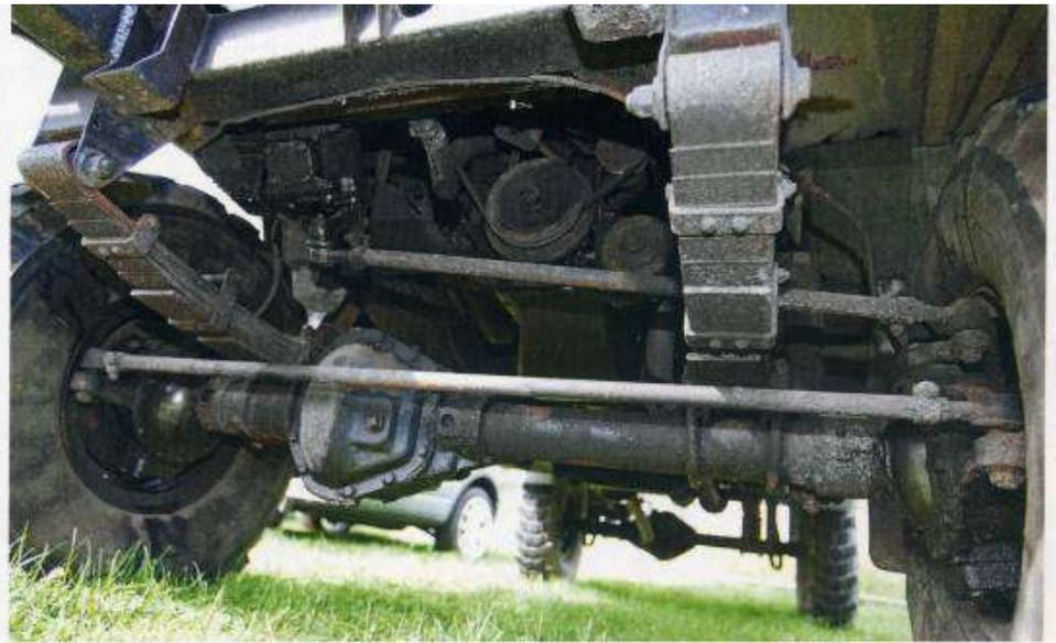
Les ponts Timken de camion ne partagent pas de pièces avec les Land traditionnels. Ils sont placés sous les ressorts à lames renforcés.
