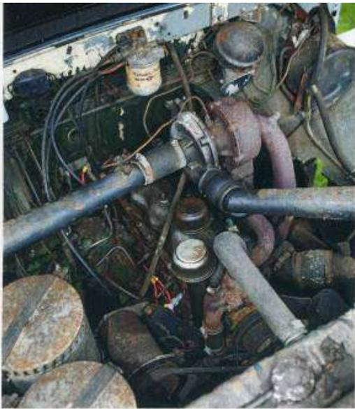
Le Diesel 2,25L réalesé à 2,5L et muni du turbocompresseur CAV a été mis au point 20 ans avant que Land Rover ne le propose de série.
